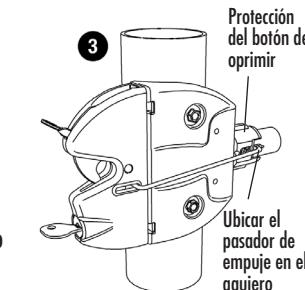
3. Para ayudar con la instalación, el botón de oprimir está trabado. Colocar el ensamblaje del botón de oprimir contra el lado opuesto del soporte redondo del poste desde la caja del cerrojo. Colocar el regreso
